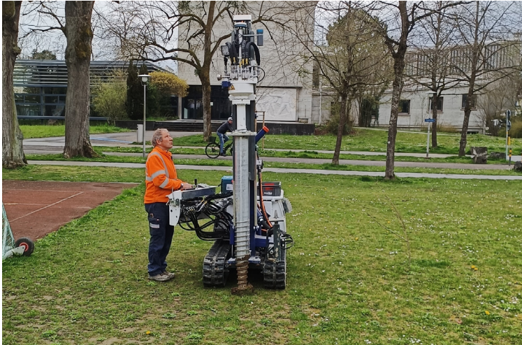
Eindrehversuche mit dem Raupenfahrzeug KRD 30
