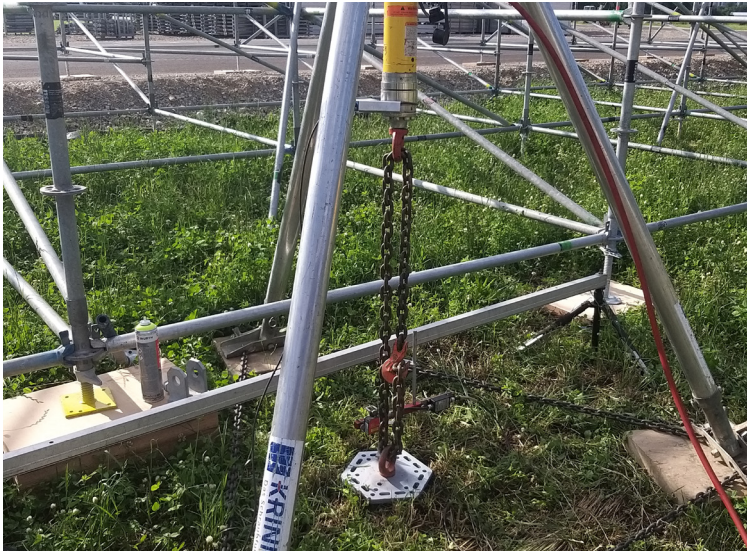
Sicherstellung Lastabtrag durch Abnahmeprüfung auf Zug
