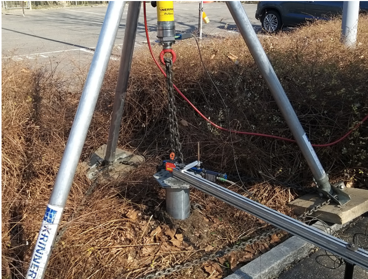
Durchführung eines Zugversuches mit Krinner Spezialequipment
